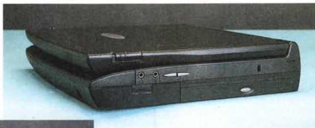
Lato sinistro: il connettore di alimentazione, le porte PCMCIA, e il floppy; il quadratino all'estrema sinistra è la predisposizione per il modem
